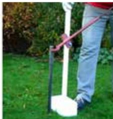
Ziehvorgang des Bohrstocke
